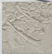
LEHM-BETON-LOOK 3 maliger Auftrag, glänzend mit Tierrfino wax versiegelt mit 50% Wasser verdünnt
