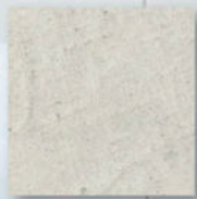
LEHM-BETON-LOOK mit DRY-PAINT gemischt Oberfläche mit Tierrfino wax versiegelt
