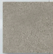
LEHM-BETON-LOOK 2 maliger Auftrag mit Tierrfino Olivenseife 2x versiegelt
